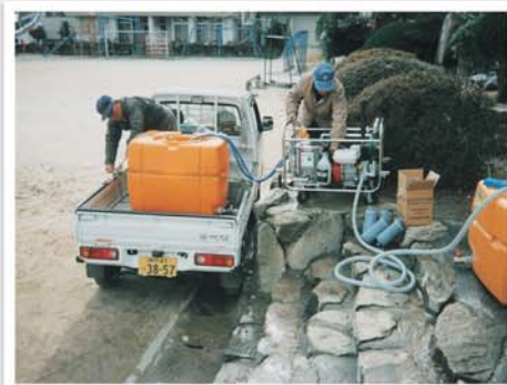
▲阪神・淡路大震災時 北淡町で(平成7年1月) 緊急時浄水装置を飲料水・生活用水として活用
